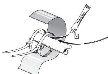
Der Fühler wird mit Kabelbinder, Wärmeleitpaste und Aluminiumklebeband angebracht. Anschließend ist er mit dem beiliegenden Isolierband zu umwickeln.
