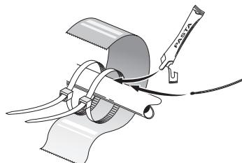
Temperaturgivaren monteras med buntband tillsammans med värmeleddningspasta och aluminiumtejp. Därefter ska den isoleras med medföljande isolertejp.
