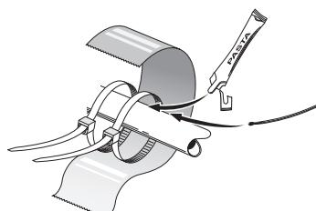
Temperaturføleren monteres med kabelbindere sammen med varmeledningspasta og aluminiumstape. Derefter skal den isoleres med den medfølgende isoleringstape.
