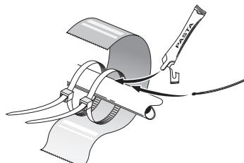
Lämpötila-anturi asennetaan nippusiteillä lämmönjohtotahnan ja alumiiniteipin kanssa. Sen jälkeen se eristetään mukana toimitetulla eristysteipillä.
